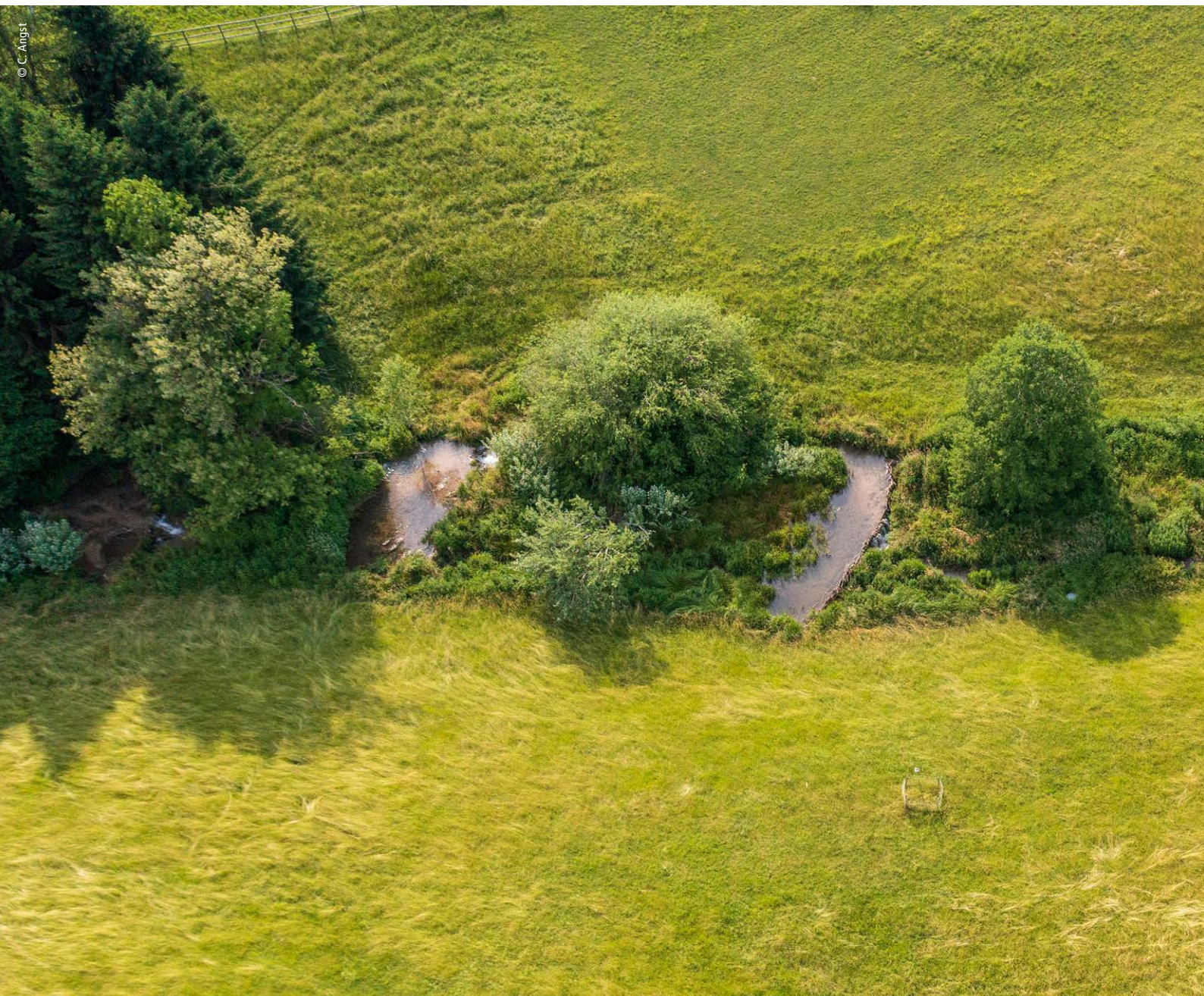
Schwammland am Schlossbach, Rümligen BE. Mit dem Einbau von sechs künstlichen Biberdämmen (BDAs) konnte beim ehemals eingetieften Bachlauf neben der hydrologischen Verbesserung (Anreicherung Grundwasser, Resilienz für lokale Trinkwasserefassung) auch eine deutliche ökologische Aufwertung erzielt werden (Minnig et al. 2025).
